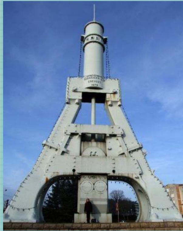
***По типу привода молоты подразделяют*** на паровоздушные, пневматические, механические, гидравлические, газовые и высокоскоростные
