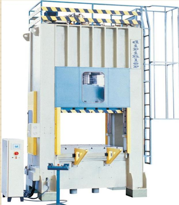
**Гидравлический пресс** — это промышленная машина, которая позволяет, прилагая в одном месте небольшое усилие, одновременно получать в другом месте высокое усилие. Гидравлический пресс состоит из двух сообщающихся гидравлических цилиндров (с поршнями) разного диаметра. Цилиндр заполняется гидравлической жидкостью: водой, маслом или другой подходящей жидкостью
