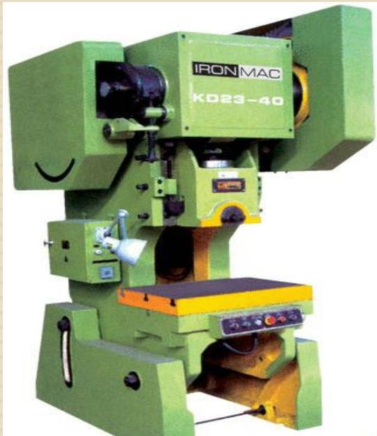
*Кривошипные прессы* применяют для вытяжки, гибки, прошивки, вырубки, резки, правки, штамповки и т. д. Кривошипные прессы в приводе имеют кривошипные механизмы, преобразующие вращательное движение электродвигателей в возвратно-поступательное движение инструмента
