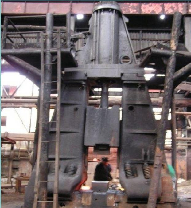
*Паровоздушные молоты* приводятся в действие паром или сжатым воздухом, вырабатываемым соответственно в паровых котлах или компрессорных установках. Пар или сжатый воздух поступает по трубопроводам в рабочий цилиндр молота и, действуя на поршень, осуществляет подъем и разгон падающих частей молота. Нанося удар по заготовке, подвижные части осуществляют деформирование металла
