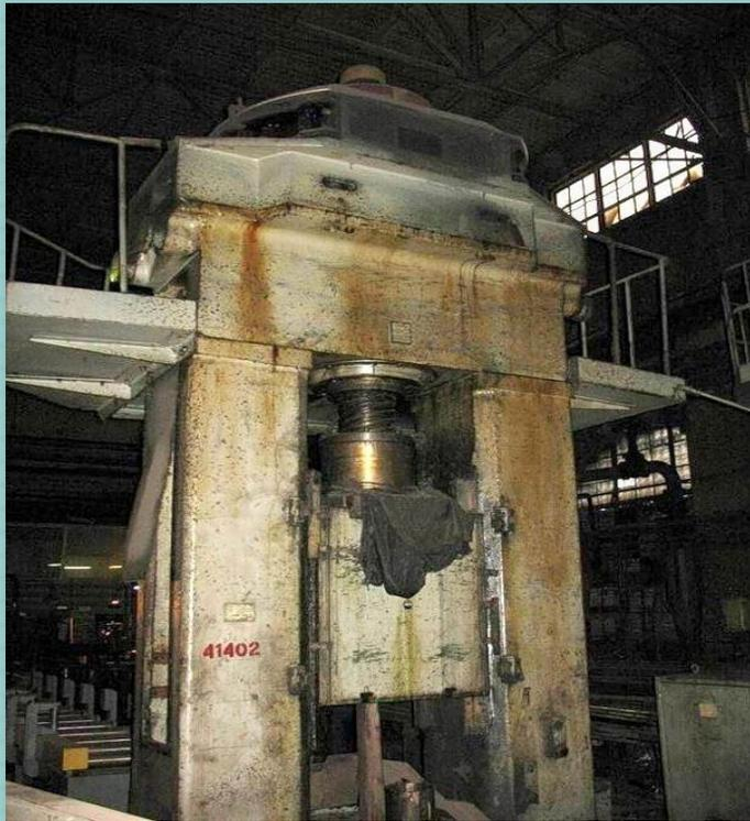
**Принцип действия винтового пресса** заключается в сообщении движения винтового шпинделя ползуну. Существует также деление винтовых прессов по направлению движения ползуна на вертикальные (они используются, в частности, для штамповки) и горизонтальные (для прессования)
